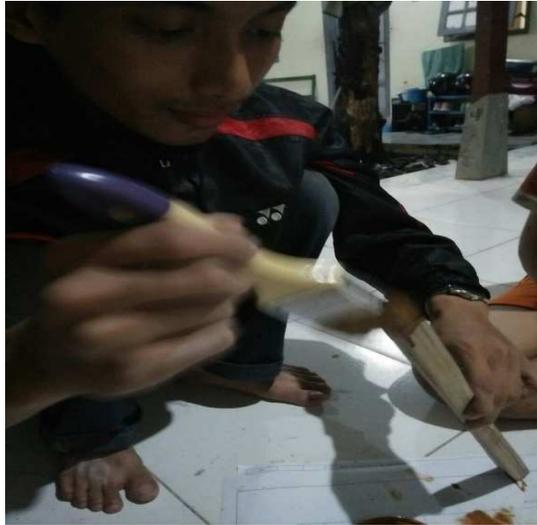
Gambar 3.4 Proses pengaplikasian cat pada spesimen laminasi bilah bambu dengan menggunakan kuas
