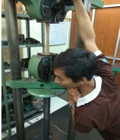
Gambar 3.11 Proses pengujian tarik spesimen laminasi bilah bambu
