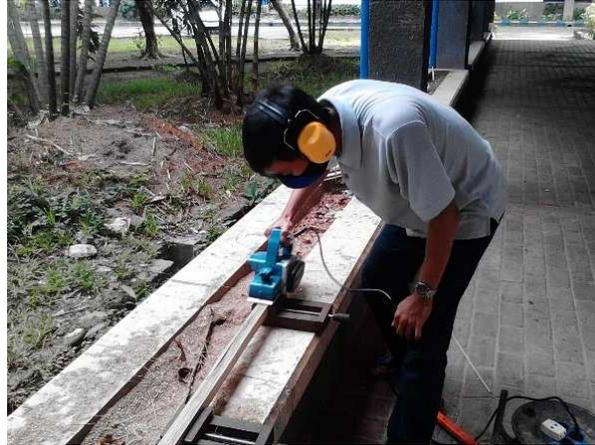
Gambar 3.3 Proses pengetaman sisi bilah-bilah bambu dengan mesin *planer* manual (*handplaner machine*)
