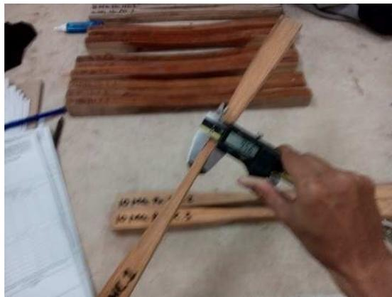
Gambar 3.10 Pengukuran lebar pada bagian tengah spesimen dengan menggunakan jangka sorong
