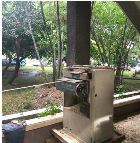
Gambar 3.2 Proses pengetaman bilah bambu dengan mesin *planer* semiotomatis (*semi-automatic planer machine*)
