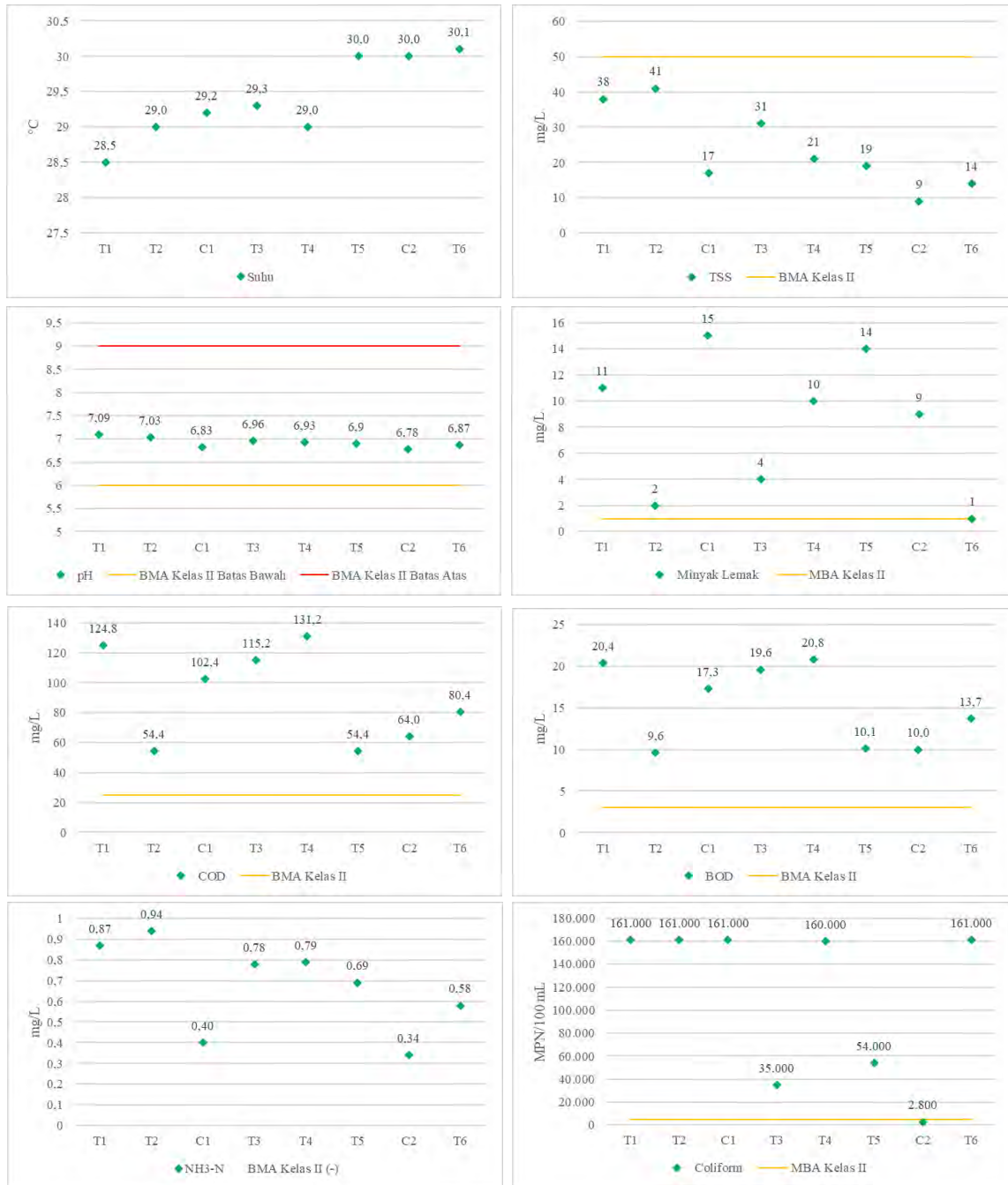
Gambar 4.17 Nilai Paramater hasil uji dan garis batas baku mutu air setiap titik pengambilan sampel
