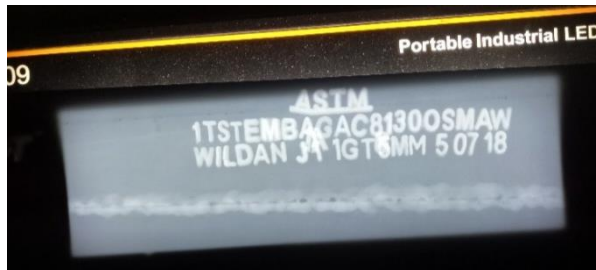
Gambar 4.6 Film Hasil Uji Radiografi Heat Input 1224.239 J/mm. (Gambar 4.5)
