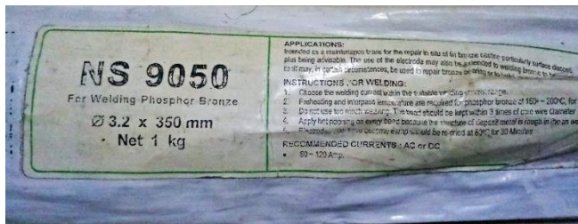
Gambar 3.8 Spesifikasi dan Parameter Filler NS 9050
