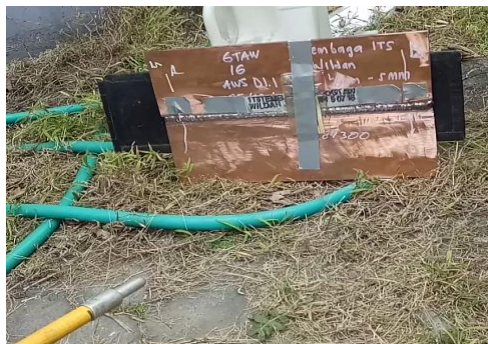
Gambar 3.14 Proses Uji Radiografi
