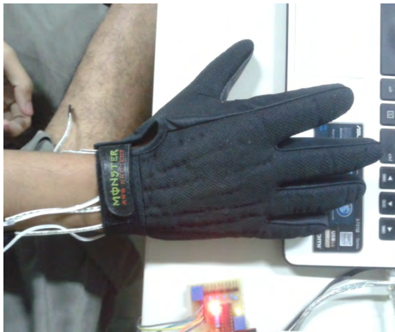
Gambar 3.21 Sarung Tangan telah Dipasang Sensor flex
