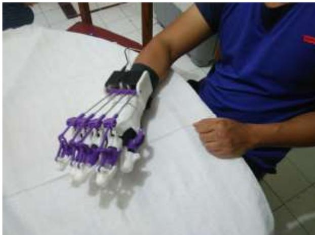
Gambar 4.23 Eksoskeleton terpasang pada pergelangan tangan
