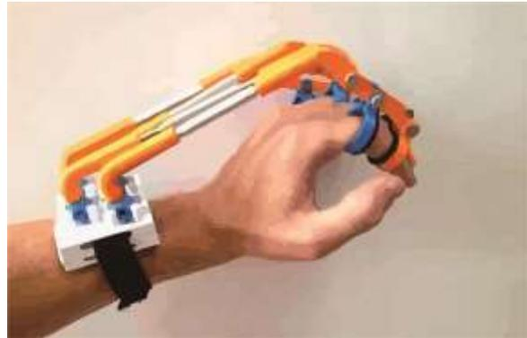
Gambar 1.7 Eksoskeleton aktif menggunakan otot pengguna untuk menutup jari
