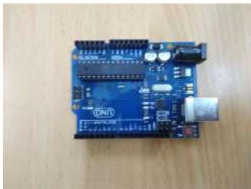
Gambar 2.12. Rangkaian mikrokontroler Arduino UNO
