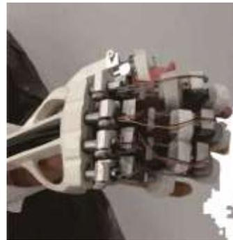
Gambar 1.5 *Precision Grip* Eksoskeleton
