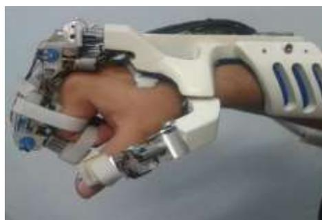
Gambar 1.6 Eksoskeleton pasif menggunakan sensor EMG
