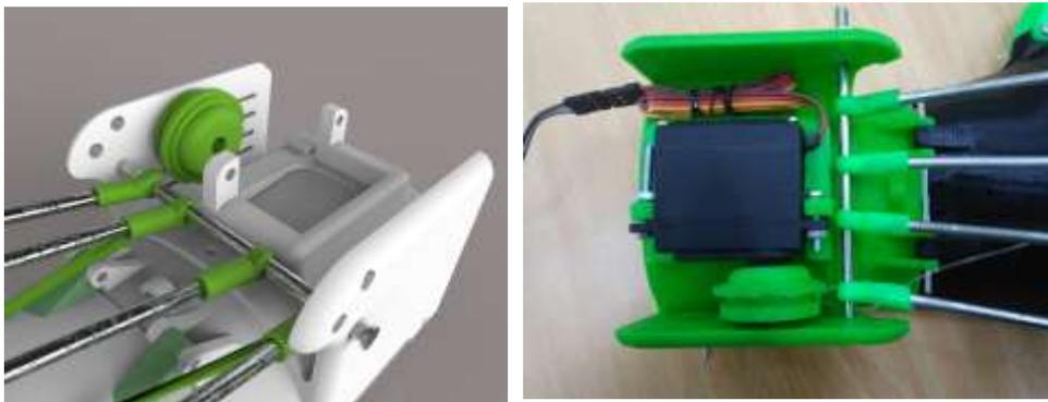
Gambar 4.16 Servo MG946R dan sistem reel menggunakan senar gitar
