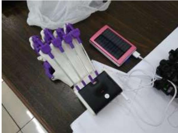
Gambar 4.22 Eksoskeleton tersambung dengan *powerbank*
