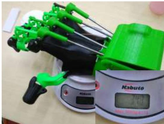
Gambar 4.24 Pengukuran bobot eksoskeleton
