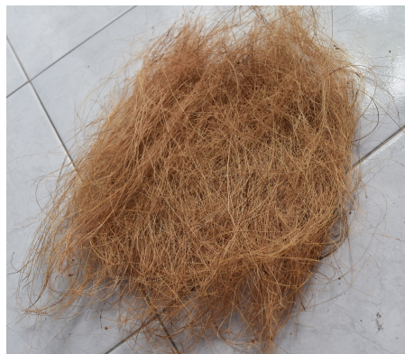
Gambar 31. Serat sabut panjang siap di cetak (Tyas, 2018)
