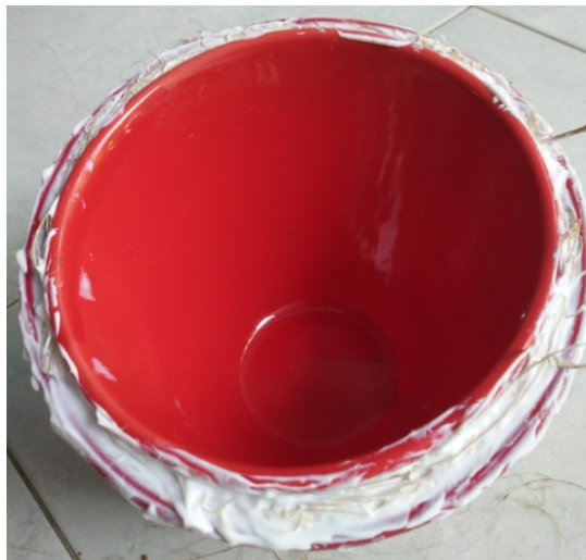
Gambar 37. Proses press manual (Tyas, 2018) diratakan pinggirannya, Diamkan semalaman.
