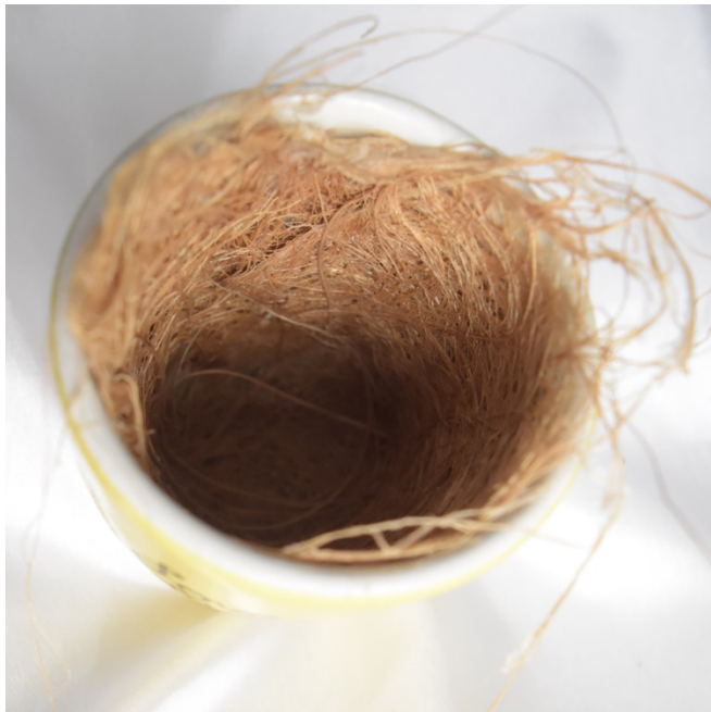
Gambar 33. Serat sabut kelapa didalam cetakan gelas (Tyas, 2018)
