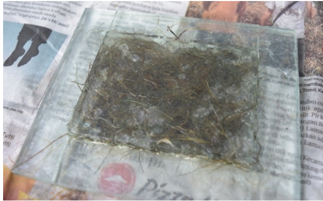
Gambar 15. Serat sabut kelapa yang sudah diberi resin (Tyas, 2018)
