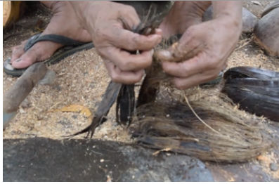
Gambar 7. Proses pemisahan serat dari kulit (Tyas, 2018)
