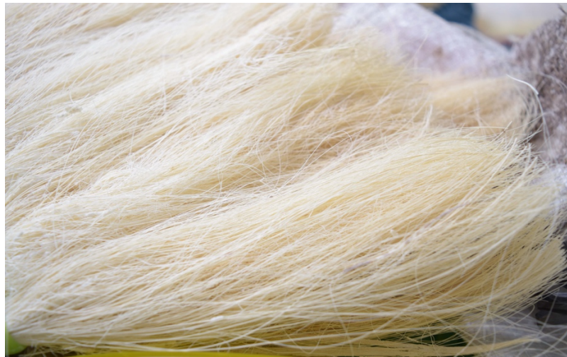
Gambar 44. Serat sabut kelapa yang telah di bleaching (Tyas, 2018)
