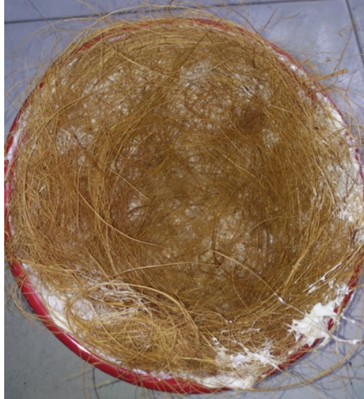
Gambar 36. Proses pengeleman serat dengan cetakan mangkok (Tyas, 2018) telah di beri lem putih.
