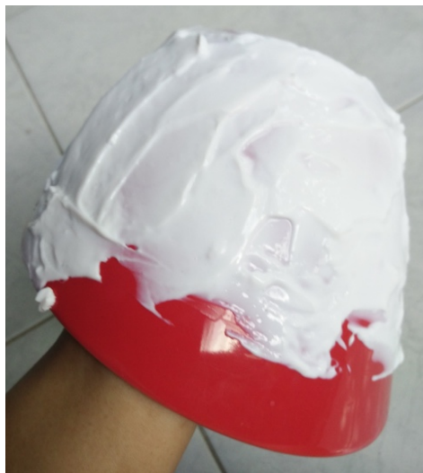
Gambar 35. Cetakan mangkok yang diberi lem putih(Tyas, 2018)
