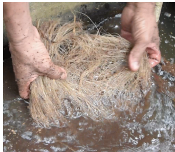
Gambar 9. Proses pembersihan serat sabut kelapa (Tyas, 2018)
