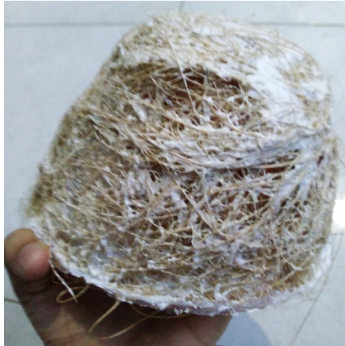
Gambar 38. Serat sabut kelapa dengan lem setengah kering
