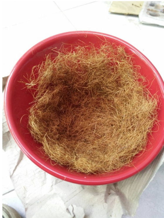
Gambar 21. Serat sabut kelapa serat pendek dalam cetakan mangkok (Tyas, 2018)
