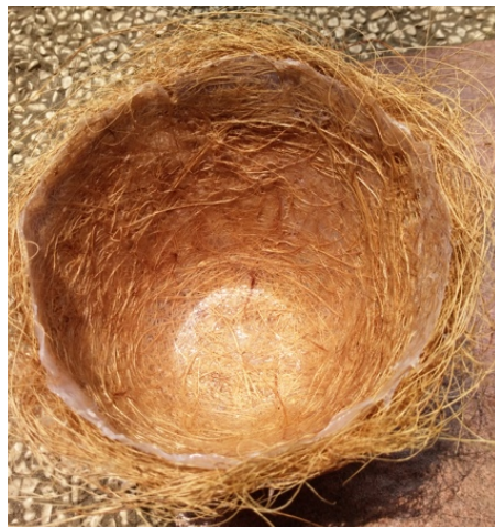
Gambar 39. Proses pengeringan serat sabut kelapa dengan cetakan mangkok (Tyas, 2018)
