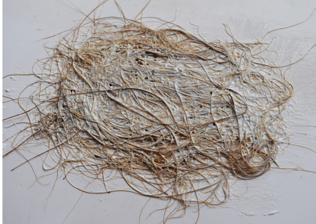
Gambar 32. Serat sabut kelapa diberi lem putih (Tyas, 2018) mengering.
