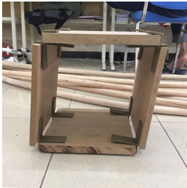
Gambar 4. 20 Struktur goyang dan sambungan mudah lepas
