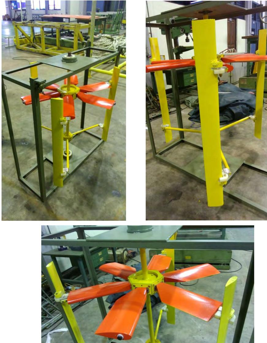
Gambar 3.11 *Darrieus turbine dan wells rotor*
