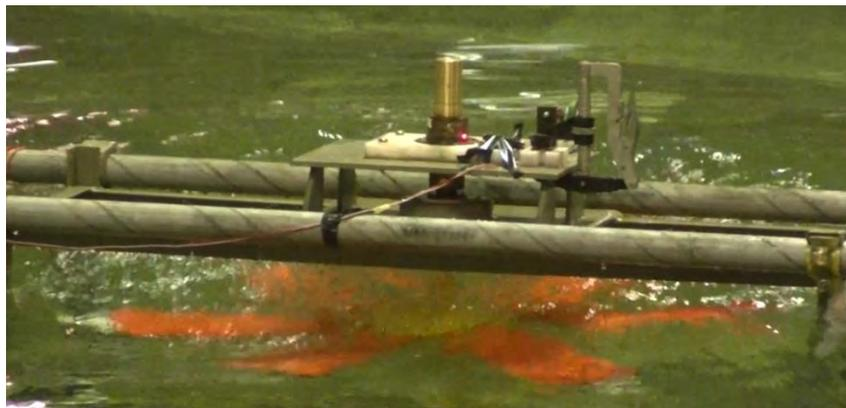
Gambar 3.18 pengujian wells rotor
