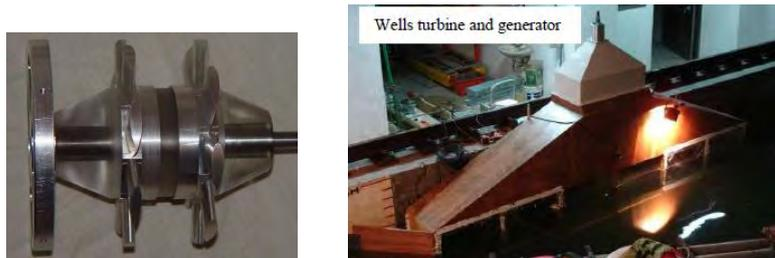
Gambar 4.18 Wells rotor double stage dan pengujiannya
