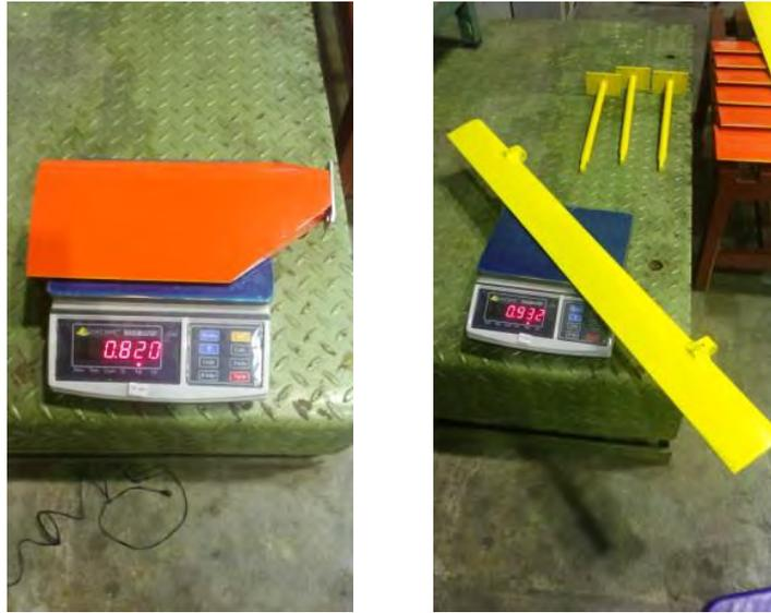
Gambar 3.12 Proses penimbangan masing-masing komponen turbin
