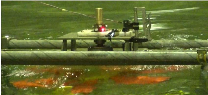
Gambar 3.21 Pengujian turbin kombinasi wells dan darrieus
