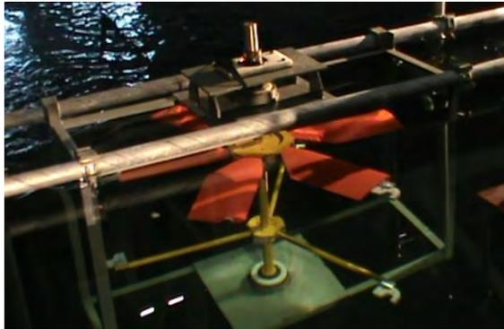
Gambar 3.25 konfigurasi 1 saat pengujian wells rotor dengan arus
