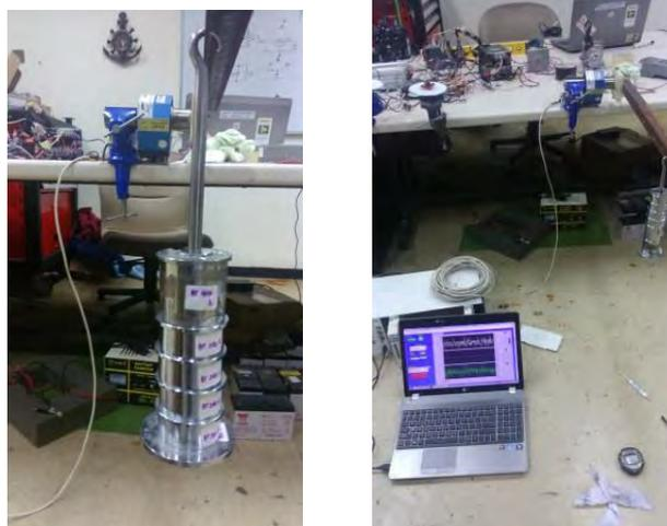
Gambar 3.13 *Torquemeter* dan proese kalibrasi
