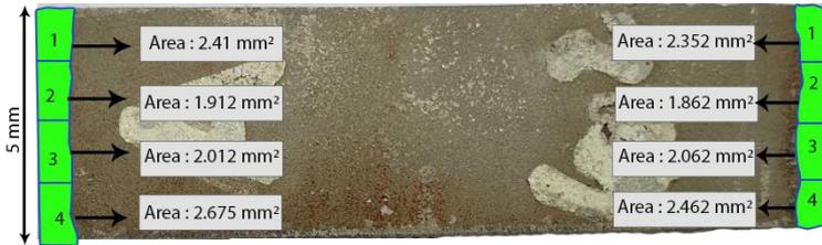
Gambar 4.20 Foto Luas HAZ pada Awal Pemotongan dengan Tekanan 6 Bar
