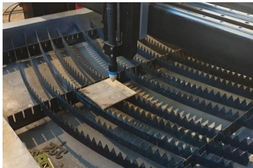
Gambar 3.9 Posisi *Torch* pada Proses pemotongan *Stainless Steel* SUS 304
