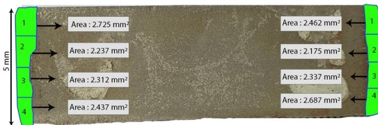
Gambar 4.24 Foto Luas HAZ pada Akhir Pemotongan dengan Tekanan 6 Bar
