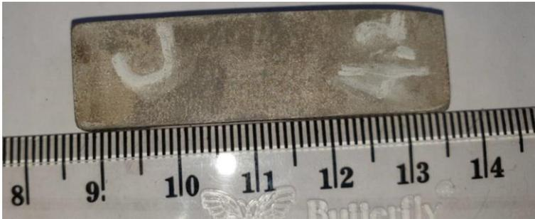
Gambar 4.11 Foto Makro pada Akhir Pemotongan dengan Tekanan 4 Bar
