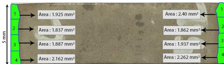
Gambar 4.18 Foto Luas HAZ pada Akhir Pemotongan dengan Tekanan 5 Bar
