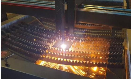
Gambar 3.10 Proses Pemotongan *Stainless Steel* SUS
