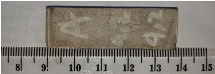
Gambar 4.7 Foto Makro pada Awal Pemotongan dengan Tekanan 4 Bar
