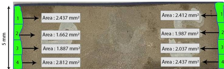
Gambar 4.16 Foto Luas HAZ pada Tengah Pemotongan dengan Tekanan 5 Bar
