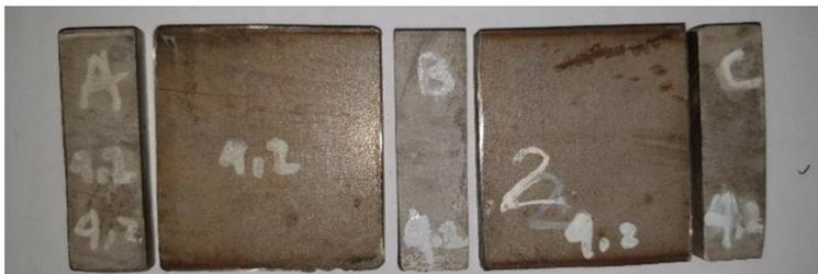
Gambar 4.31 Hasil Potongan pada Tekanan 4 Bar
