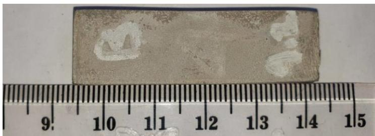
Gambar 4.9 Foto Makro pada Tengah Pemotongan dengan Tekanan 4 Bar
