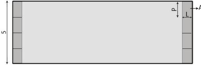
Gambar 3.21 Metode Pengukuran HAZ
