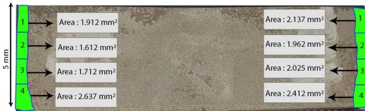
Gambar 4.10 Foto Luas HAZ pada Tengah Pemotongan dengan Tekanan 4 Bar
