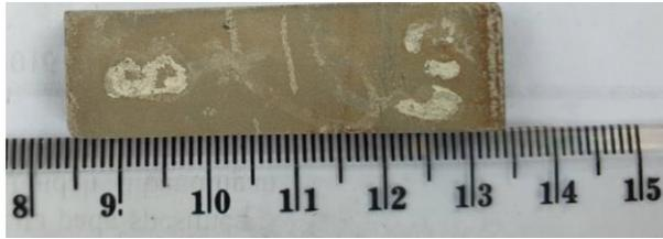
Gambar 4.21 Foto Makro pada Tengah Pemotongan dengan Tekanan 6 Bar
