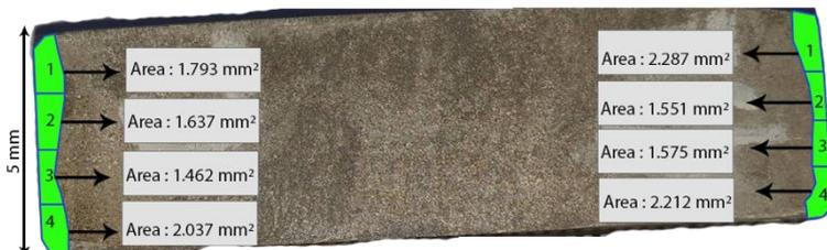
Gambar 4.12 Foto Luas HAZ pada Akhir Pemotongan dengan Tekanan 4 Bar
