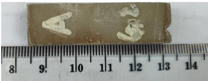
Gambar 4.19 Foto Makro pada Awal Pemotongan dengan Tekanan 6 Bar
