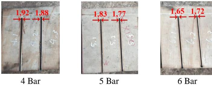
Gambar 4.34 Jarak Celah Pemotongan *Stainless Steel* SUS 304
