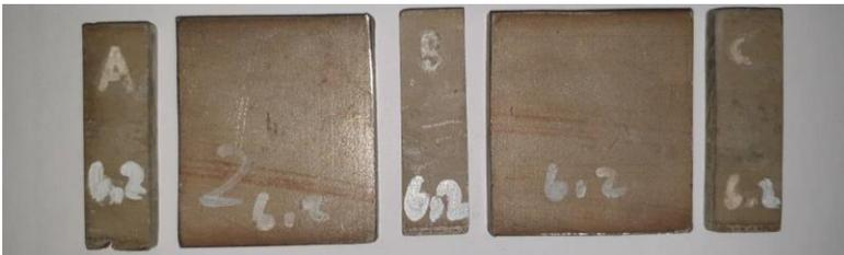
Gambar 4.33 Hasil Potongan pada Tekanan 6 Bar
