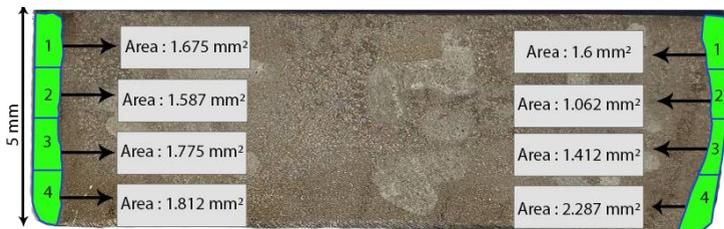
Gambar 4.8 Foto Luas HAZ pada Awal Pemotongan dengan Tekanan 4 Bar
