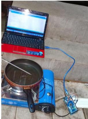
**Gambar 4.11** Kalibrasi Sensor Suhu
