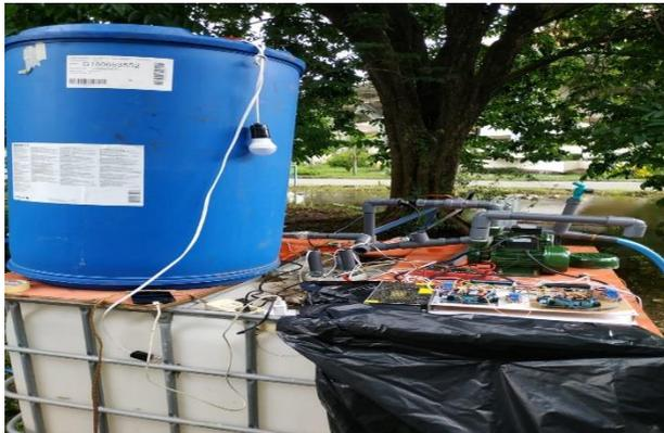
**Gambar 4.1** Sistem Kontrol Level dan Kekeruhan pada proses penjernihan air
