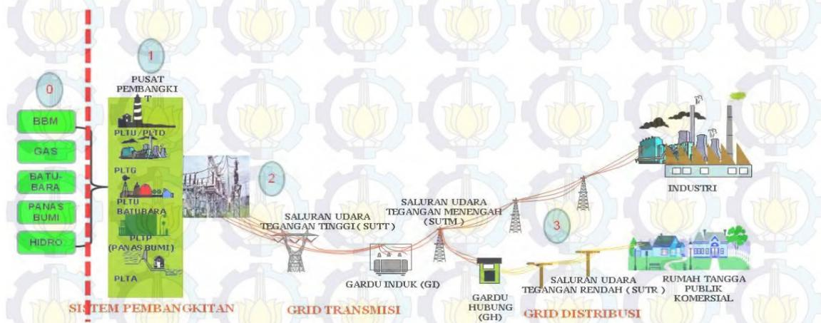
Gambar 2.9 Alur Penyaluran Energi Listrik
