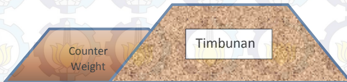
Gambar 2.8 Counterweight pada timbunan
