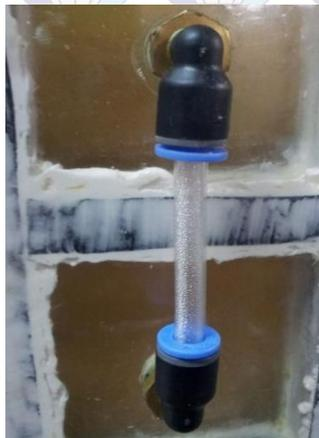
**Gambar IV.26** Pelarut yang Terbawa oleh Aliran Gas
