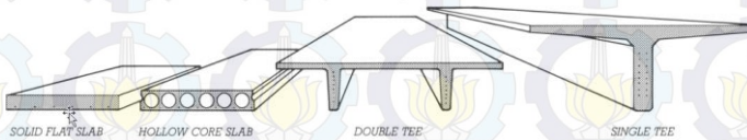
Gambar 2.1: Jenis-jenis penampang pelat pracetak Sumber: PCI 6 Edition
