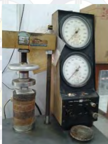
Gambar 9 Uji kuat tekan
