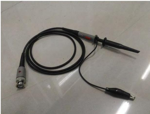
**Gambar 3.17** Probe osiloskop
