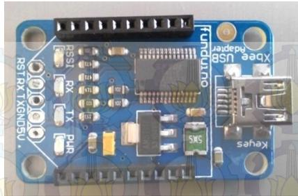
**Gambar 3.5** FT232RL Pada Xbee USB Adapter
