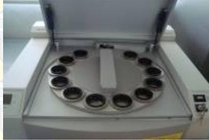
**Gambar 3.20 Mesin Uji XRF**
