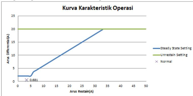
Gambar 4. 14 Kurva Karakteristik Operasi Kondisi Normal
