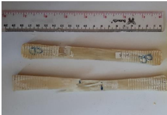
Gambar 4.3 Bentuk Patahan Specimen Uji Tarik Material Komposit Epoksi/Serat Kaca
