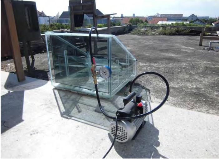
*Gambar Rangkaian Percobaan Sudut 20° dengan Vakum*
