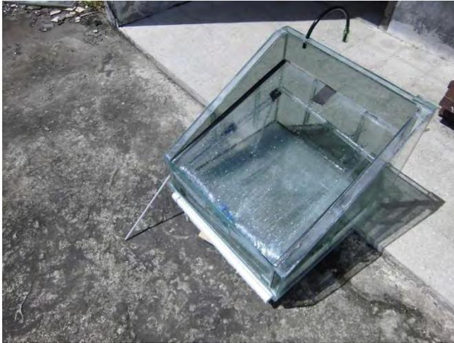
*Gambar Rangkaian Percobaan Sudut 20° tanpa Vakum*
