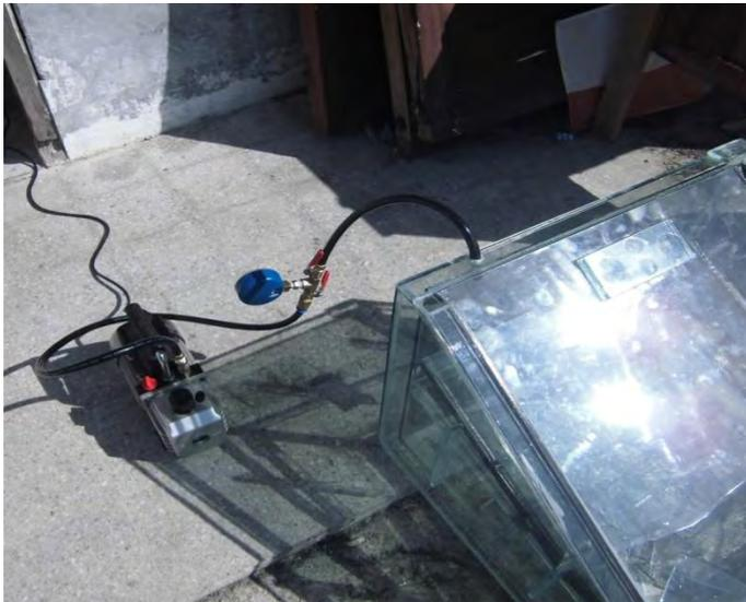
*Gambar Rangkaian Percobaan Sudut 30° dengan Vakum*
