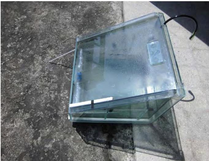
*Gambar Rangkaian Percobaan Sudut 30° tanpa Vakum*
