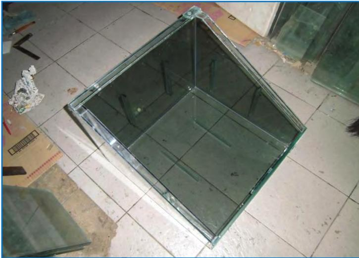
*Gambar Solar Water Destilator Saat Dibuat*
