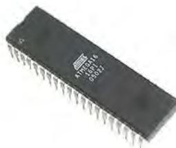
**Gambar 3.6. Mikrokontroler ATMega16.**
