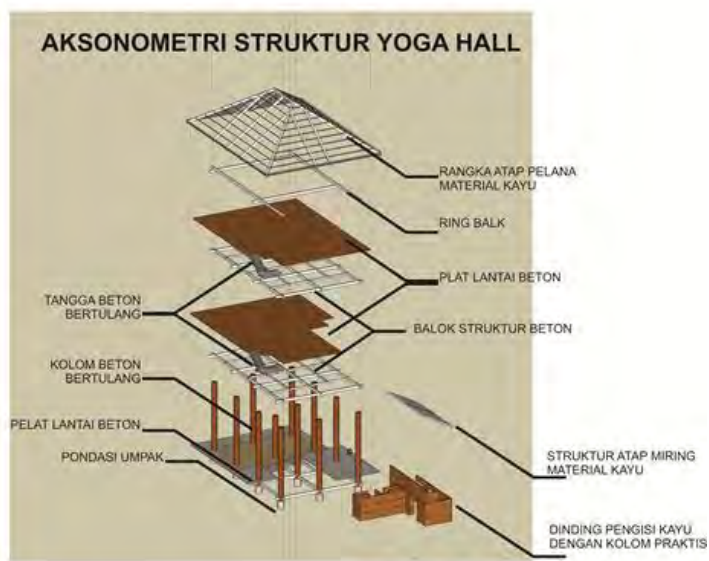
Gambar V.11 Aksonometri Struktur Bangunan Yoga Hall
