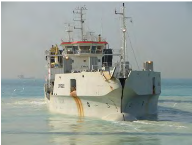
Gambar 8.7 Pembuangan Hasil Keruk Sistem Split ( Sumber : http://www.jandenul.com )
