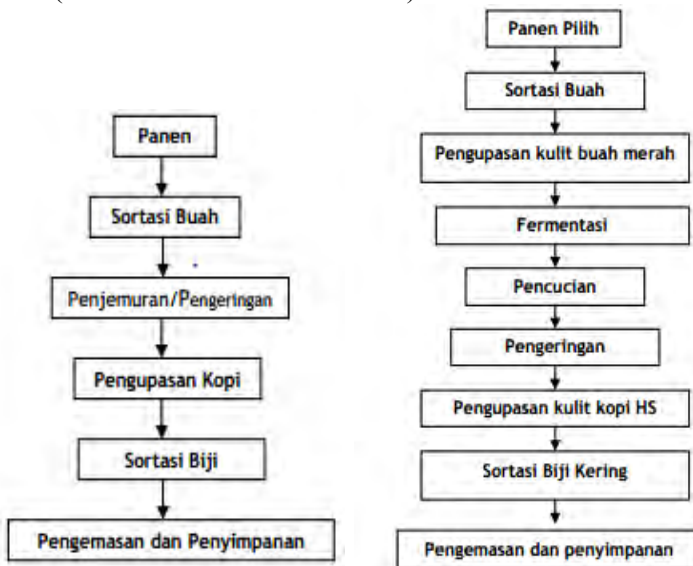
Gambar 2.1 Proses pengolahan kopi kering (kiri) dan basah (kanan) (Permentan No. 52 tahun 2012)
