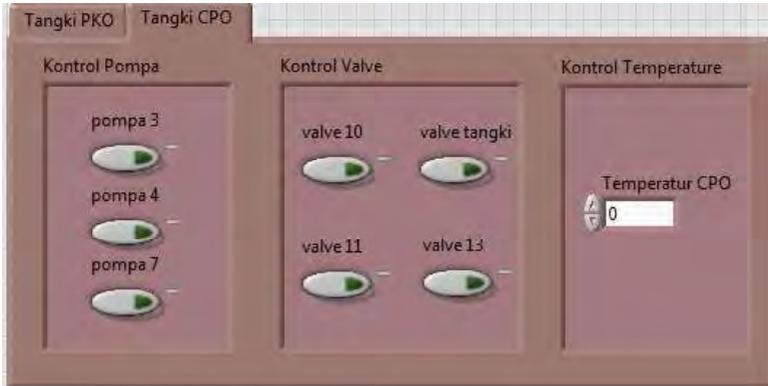
**Gambar 4-8** Tampilan HMI pada kontrol tangki CPO
