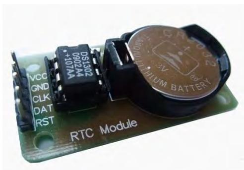
Gambar 2.10 RTC Module
