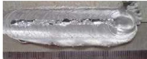
Gambar 5. Hasil Tampak Atas Pengelasan dengan RPM 1725 dan sudut 2°
