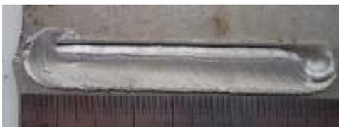
Gambar 2. Hasil Tampak Atas Pengelasan dengan RPM 1115 dan sudut 0°
