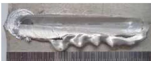
Gambar 3. Hasil Tampak Atas Pengelasan dengan RPM 1115 dan sudut 2°
