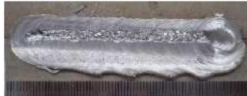
Gambar 4. Hasil Tampak Atas Pengelasan dengan RPM 1725 dan sudut 0°
