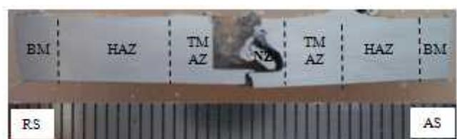
Gambar 8. Struktur Makro Pengelasan dengan RPM 1725 dan sudut 0°
