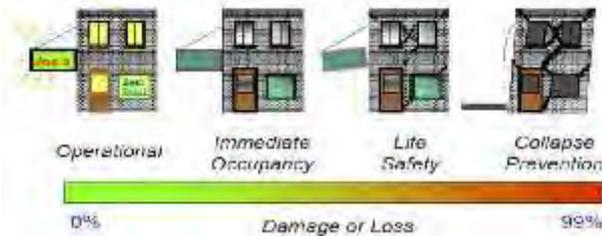
**Gambar 2.1-1 Tingkat Kinerja Struktur Bangunan FEMA 356**
