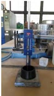
Gambar 3.7 Alat Vicat untuk Uji Konsistensi Normal
