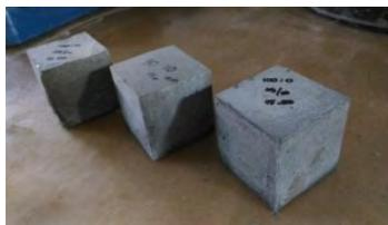
Gambar 4.3 Benda Uji Setelah Menjalani Masa Curing
