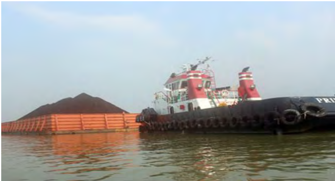
Gambar 2.6 Tugboat yang menarik sebuah tongkang (Sumber: Jawapos.com, 2016)
