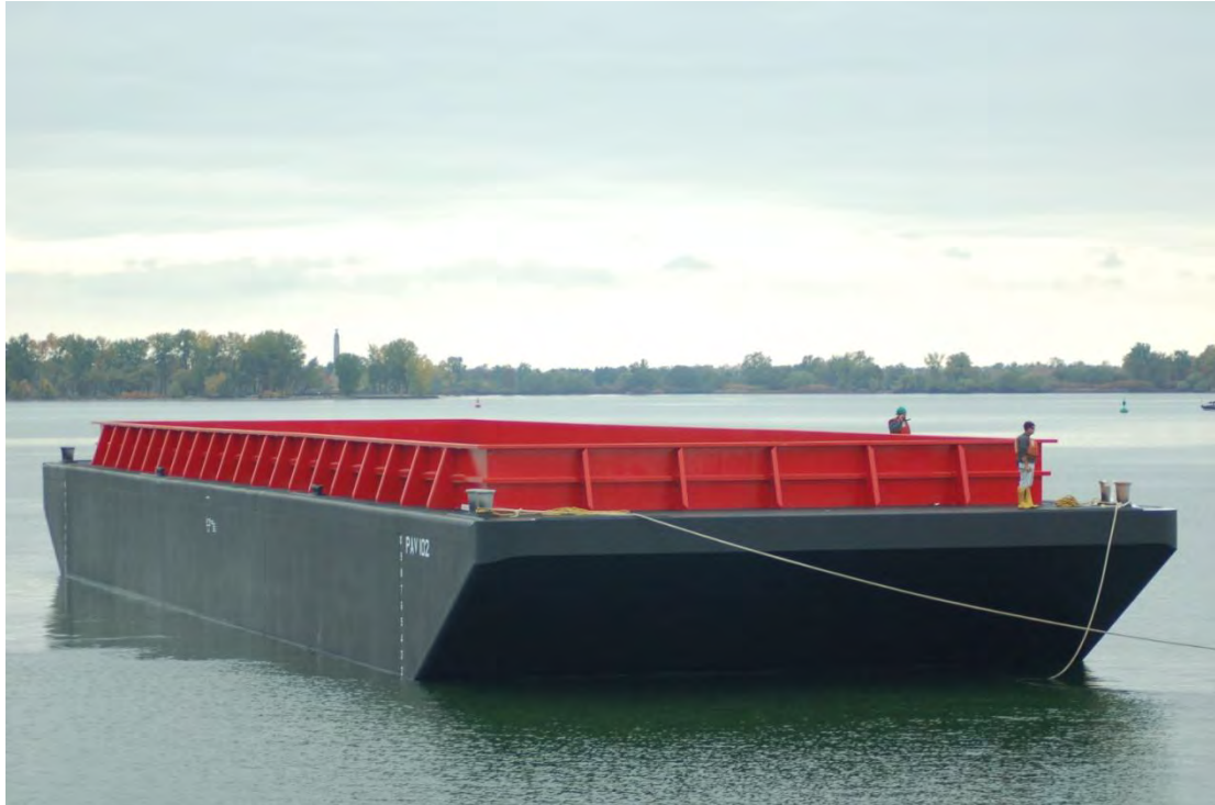
Gambar 2.7 Deck Cargo Barge dalam posisi tambat (Sumber: erieshipnews.blogspot.com , 2016)
