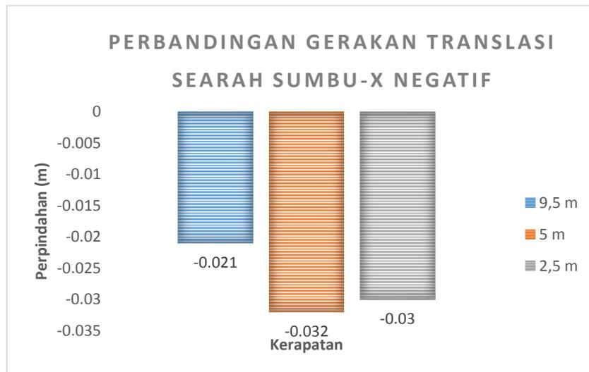
Gambar 2: Diagram perbandingan perpindahan dok apung terhadap kerapatan dermaga pada arah sumbu-x negatif.
