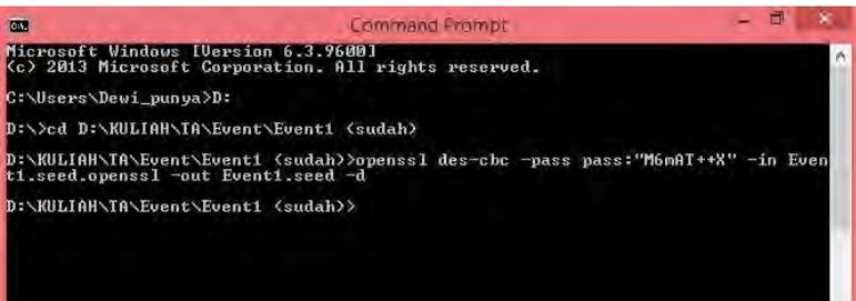
Gambar 3.4. Perintah untuk konversi dari .openssl ke .seed
