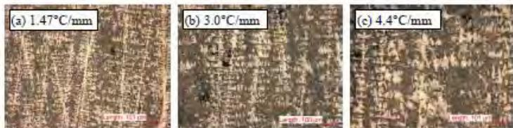
**Gambar 2.18** Struktur Mikro Paduan Al-10Si dengan Gradien Temperatur Berbeda (muhamad, 2013)
