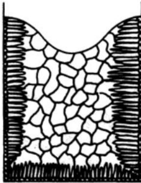
**Gambar 2.3** Struktur Ingot Coran (Smallman, 2000)
