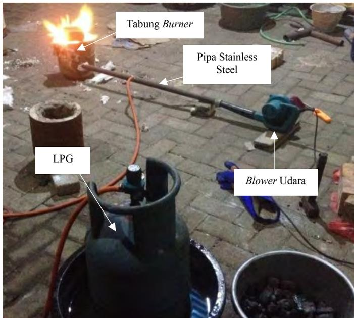
**Gambar 3.24** Skema *Burner*
