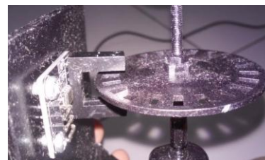
Gambar 3.5 Konstruksi sensor optocoupler dengan disk rotary encoder
