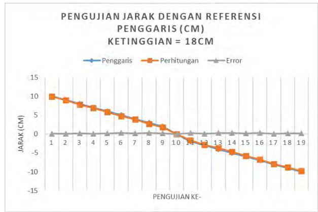
Gambar 12. Grafik Pengujian Jarak dengan Kamera.
