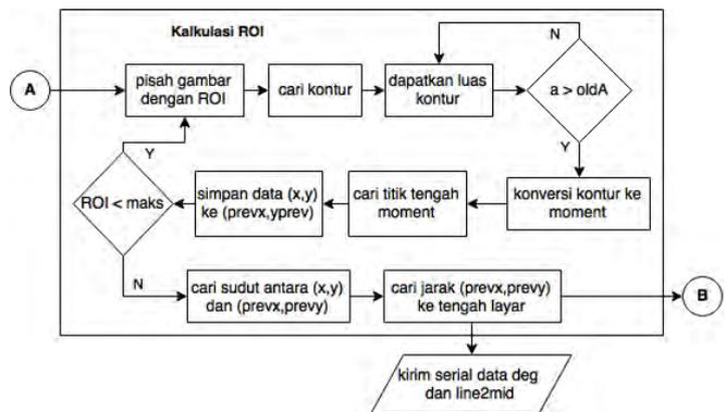
Gambar 5. Diagram Alir Proses Kalkulasi Perbelokan
