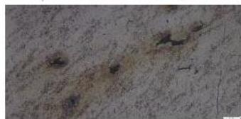
**Gambar 2.2** Void struktur mikro spesimen yang mengalami kegagalan dengan pembesaran 500x. [3]
