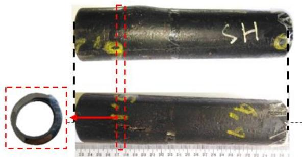
**Gambar 3.3** *Tube superheater* yang mengalami kegagalan. [3]
