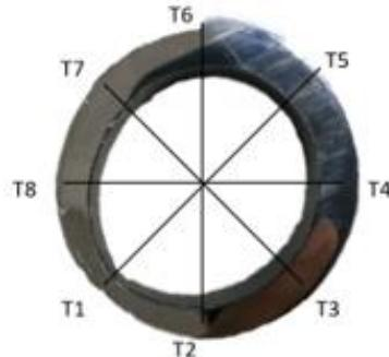
**Gambar 3.4** Potongan *tube superheater* yang mengalami kegagalan. [3]
