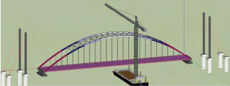
Gambar 6.5 Pemasangan deck jembatan
