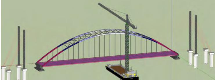
Gambar Pemasangan deck jembatan
