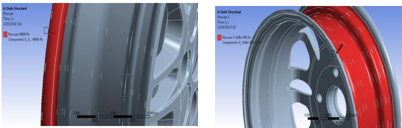
Gambar 3.2 Beban akibat tekanan ban (a) beban pada flange (b) beban pada rim
