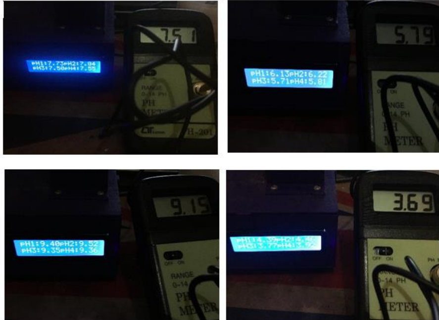
Gambar 4.6 Hasil perbandingan pengukuran pH dengan alat yang telah dikembangkan dan pH meter digital pada sampel.
