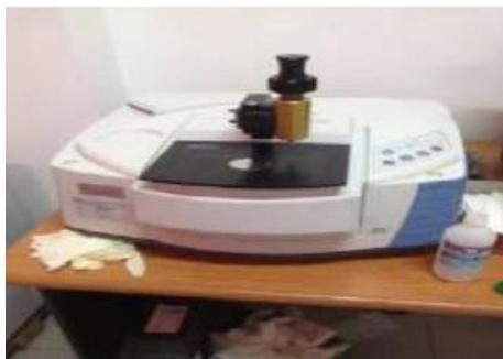
Gambar 3.6 Alat Pengujian FTIR
