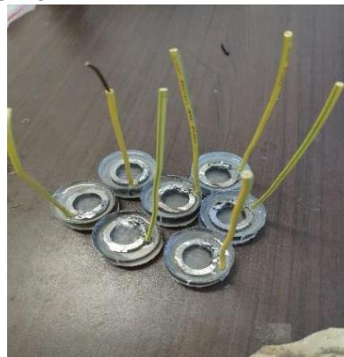
**Gambar 3.4** Spesimen Uji Polarisasi dan EIS
