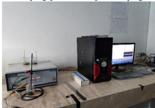
Gambar 3.5 Alat Pengujian Polarisasi Potensioidinamik
