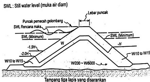
**Gambar 2. 14** tampang tiga lapis yang disarankan dengan serangan gelombang pada satu sisi
