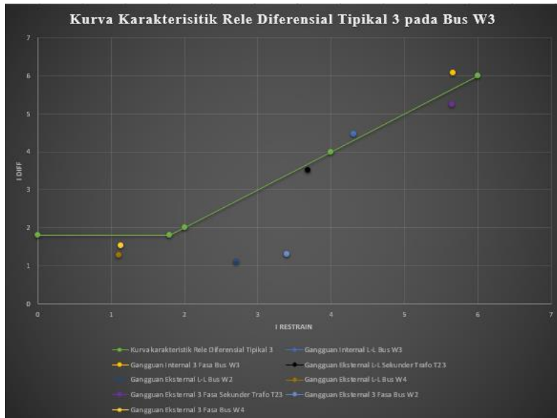
Gambar 4. 50 Kurva karakteristik Rele Diferensial Tipikal 3
