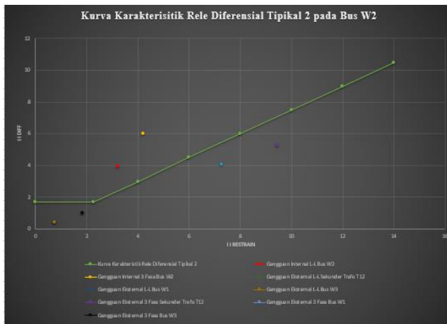
Gambar 4. 39 Kurva Karakteristik Rele Diferensial Tipikal 2
