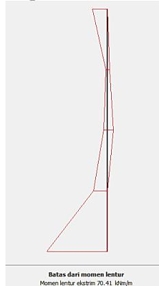
Gambar 7.9 Momen maksimum pada dinding penahan tanah eksisting
