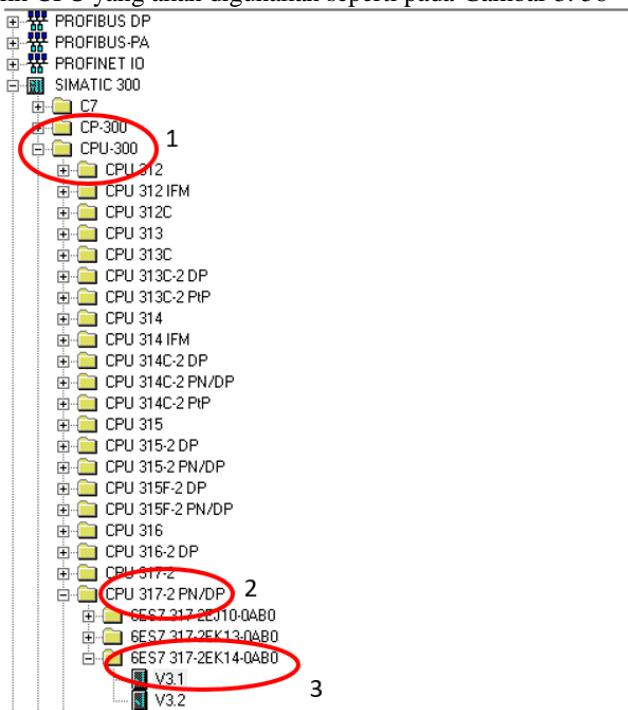
Gambar 3. 56 Pilih CPU Step 7
