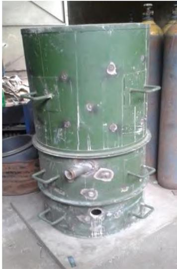
**Gambar 3.3** Reaktor Gasifikasi *Downdraft*
