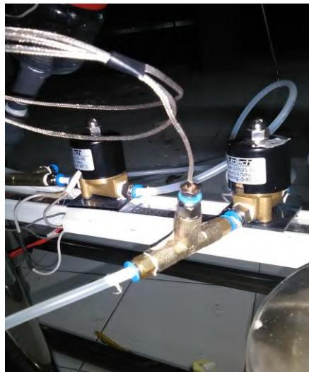
**Gambar 3.8** Peletakan Sensor Termokopel pada Plant Elektrolisis Air
