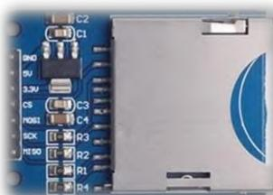
**Gambar 2.13** Modul SD Card atau MMC
