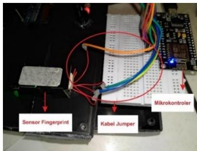
Gambar 4.12 Koneksi Sensor ke Mikrokontroler
