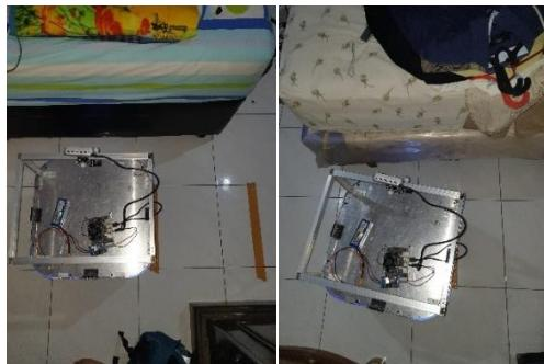
**Gambar 4.8 Pose awal dan pose setelah bergerak ke kanan sejauh 3 meter**
