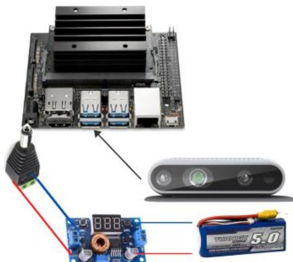
**Gambar 3.5 Rancangan elektronik pada *head module* robot**
